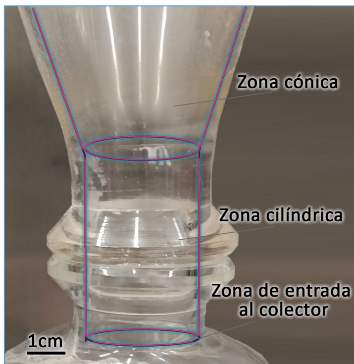
Figura 2. Posicionamiento del ciclón y depósito recolector identificando la zona cilíndrica muerta.
