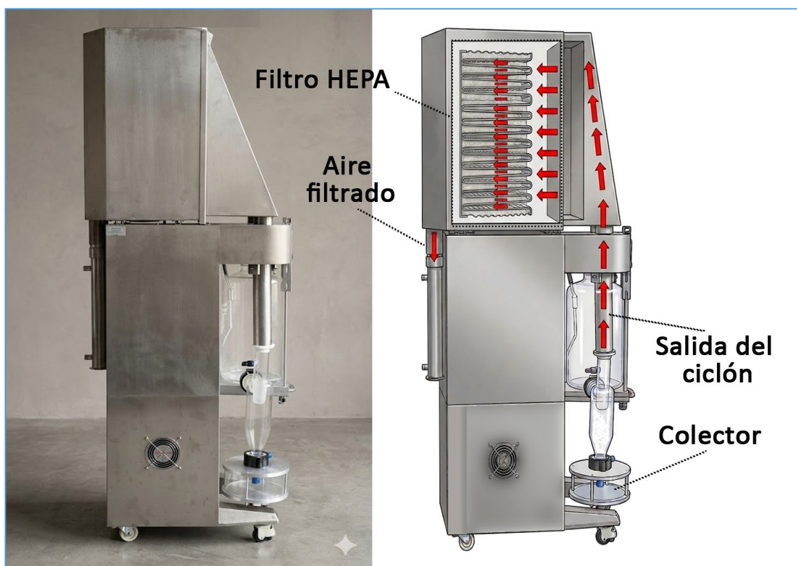
Figura 7. Equipo con la incorporación del equipo de filtrado (izquierda) y un esquema de como se circula el aire desde el ciclón hasta la zona de filtrado.
