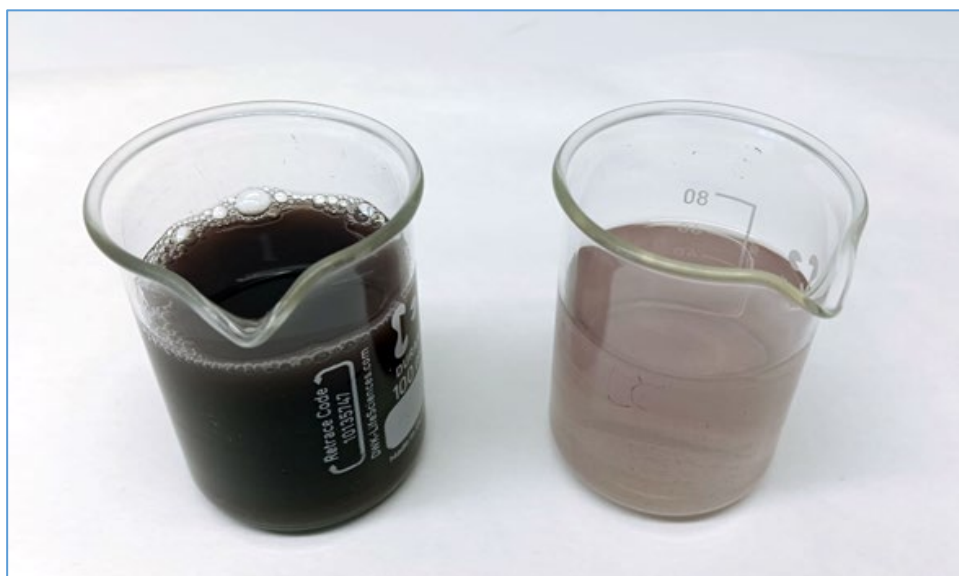
Figura 10. Comparativa de las aguas de lavado de pintura antes (izquierda) y tras s. en espray (derecha).
